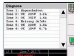
Diagnose: Klartext über den Zustand jeder Zone
